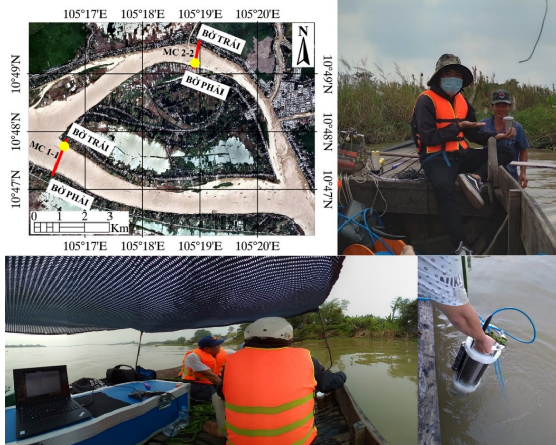
Hình 5. Đo vận tốc dòng chảy và lấy mẫu bùn cát.
